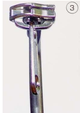
Vergewissern Sie sich, dass der Schieber am ZIPPER JIG® befestigt ist. Der Schieber kann von beiden Seiten befestigt werden.
