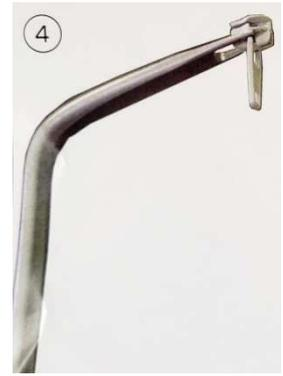
Kleinere Schieber befestigen Sie am ZIPPER JIG® wie auf der Abbildung.
