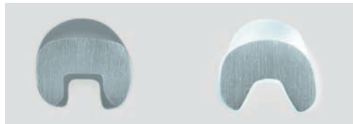
Vergleich Hohlkehlschnitt Standardnadel (links) und MR-Nadel (rechts)
