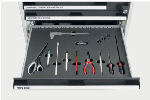
Die dritte Schublade enthält Werkzeuge für den INH-Prozess. Die abgebildeten Elemente sind im Lieferumfang enthalten. Für weitere Werkzeuge kann der Schaumstoff entsprechend zugeschnitten werden.
