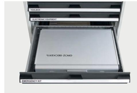
In der fünften Schublade befindet sich – optional – ein Nadelkoffer, der mit neuen Nadeln sowie mit Werkzeugen für den Nadelaustausch befüllt ist. Er kann als „Notfallkoffer“ entnommen werden für den Fall, dass zwei Nadeln zeitgleich ausgetauscht werden müssen. Diese Schublade ist ebenfalls mit dem Verschlusssystem gesichert.
