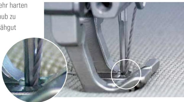
Besonders bei dicken Multifilamentfäden besteht die Gefahr, dass sich die Zwirnung in die Langrinnenkante einhakt:
