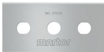
Die INDUSTRIEKLINGE NR. 37020 v on MARTOR ist eine hochwertige Klinge aus Stahl. Sie ist sehr scharf und verfügt über vier nacheinander nutzbare Schneidkanten für eine besonders hohe Einsatzzeit. Die Klinge ist 43 mm lang, 22 mm breit und 0,20 mm stark.
